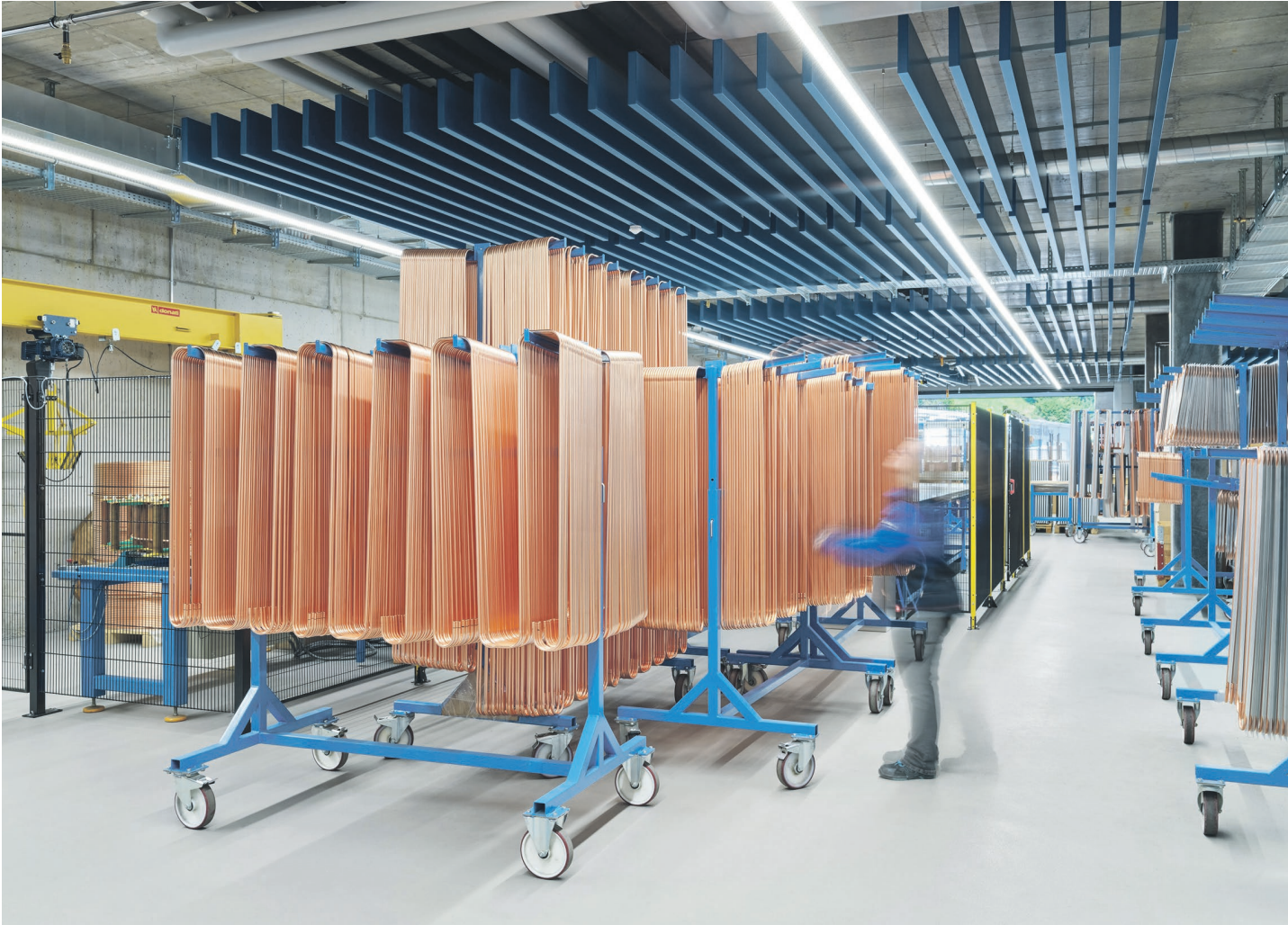
Das Herzstück jeder aktivierten Wasserkühl- und -heizdecke sind Kupferrohrmänder, die projektspezifisch gebogen werden und durch die temperiertes Wasser zur Raumklimatisierung zirkuliert.
